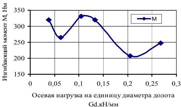
Рис. 4. Зависимость изгибающего момента от осевой нагрузки на единицу диаметра долота
